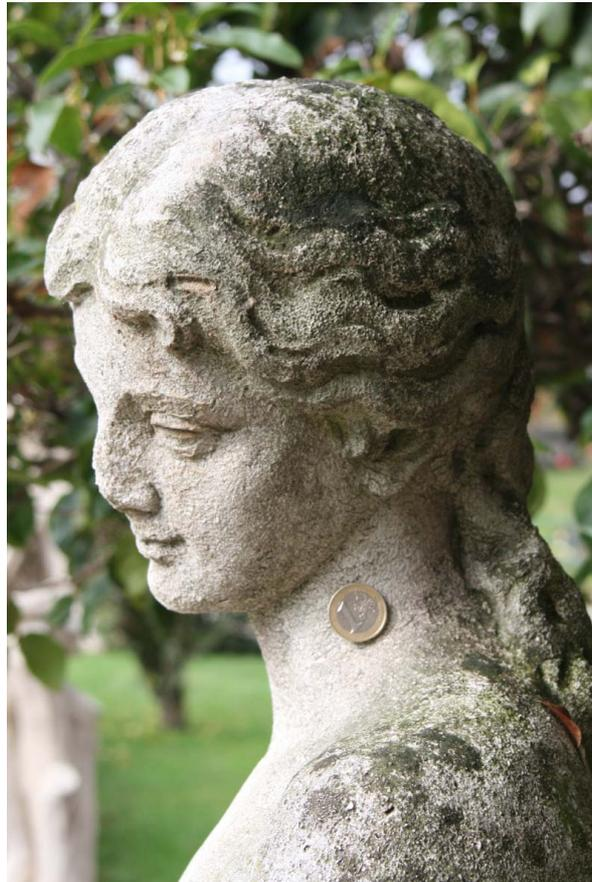
**Abb. 6:** Detail am Haupt: *Verwitterungsformengruppe Gesteinsverlust: Ausbrüche ohne erkennbare Ursache*
