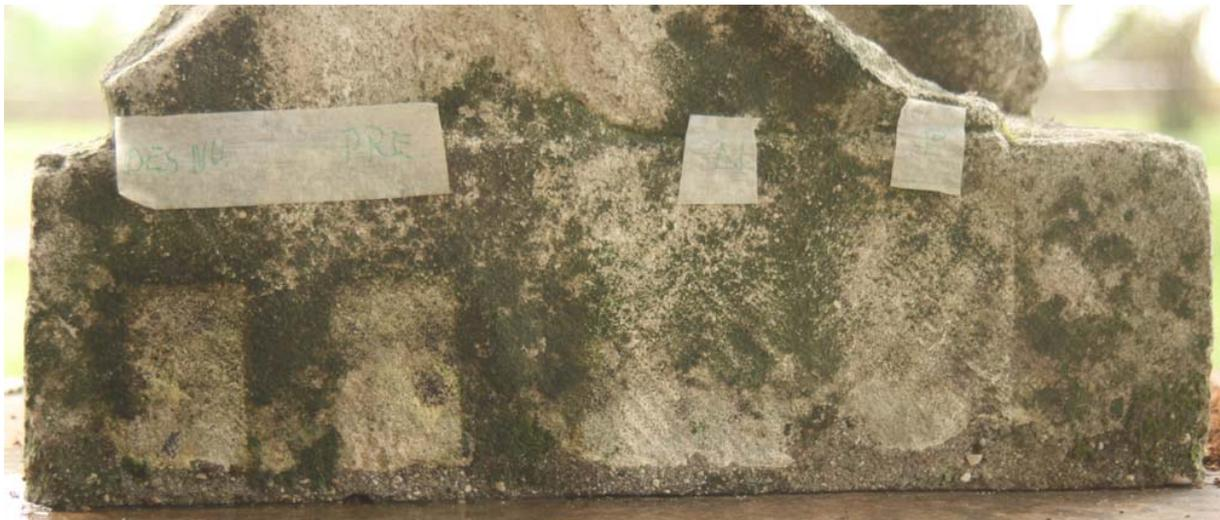
**Abb. 9:** Rückseite des Sockels nach der Reinigung mit Des Novo- und Preventolkompresse auf der linken Seite und Des Novo und Preventol in flüssiger Form auf der rechten Seite.
