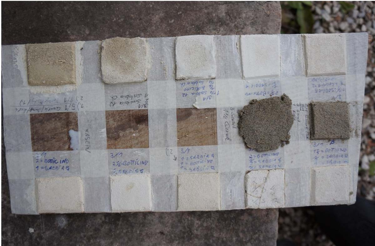
**Abb. 26:** Proben: Hydraulischer Kalk-Kaseinmörtel und Kalkmörtel
