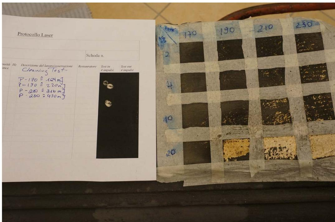
**Abb. 29:** Laserprotokoll (Energie in mJ) und Laserproben (Herz/Energie)
