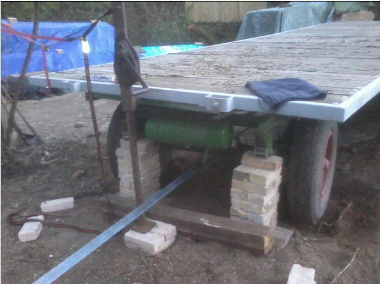
**Schritt 4:** Rolle aufbocken auf Ziegelsteinen oder Holzkonstruktion (besser 2 Personen). Ggf. unter den Rädern graben, um tiefer zu bocken.
