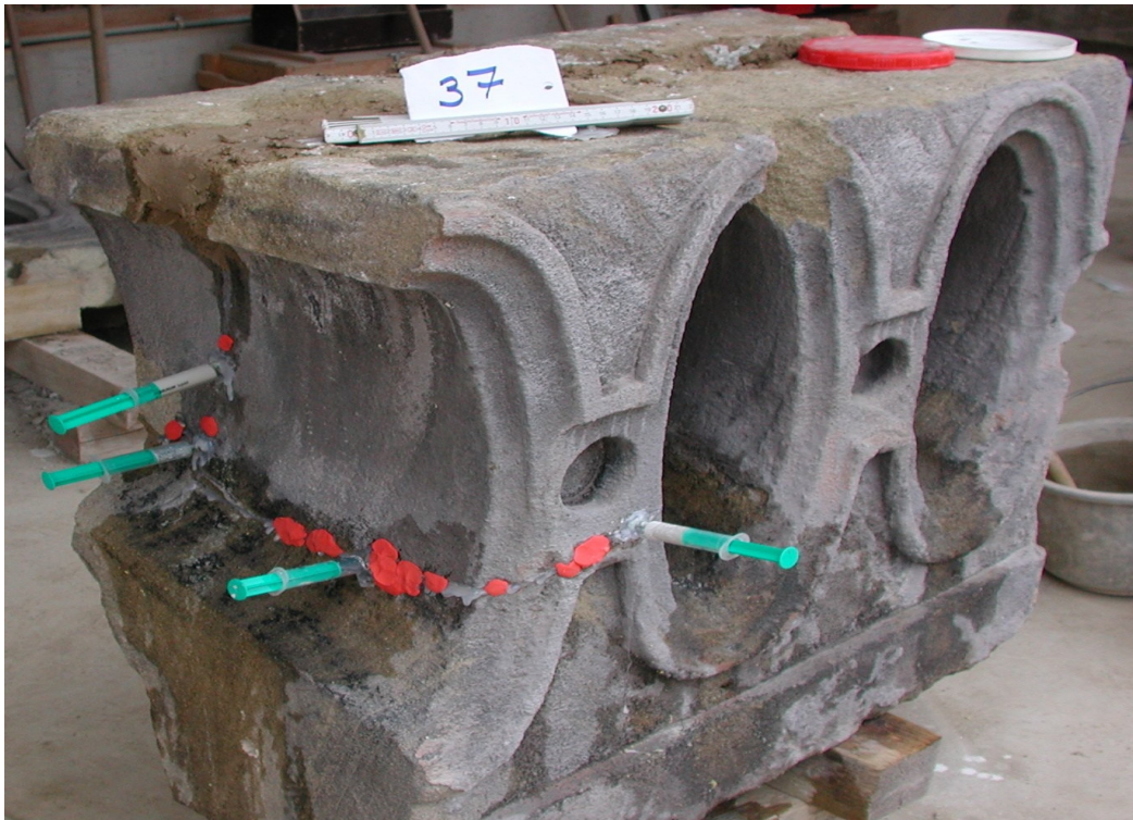
Abb. 10: Entfernung von Gummilippen, Sandstrahlreinigung mit Granatsand als Zuschlag
